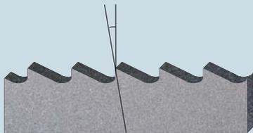
Spanwinkel positiv: mit ausgerundetem Zahngrund. Vorteilhaft beim Sägen von langspanigen Werkstoffen, z.B. NE-Metallen, Stählen mit niedrigem Kohlenstoffgehalt, Materialien mit großen Querschnitten, metallischen Werkstoffen, die beim Sägen zur Kaltverfestigung neigen.
