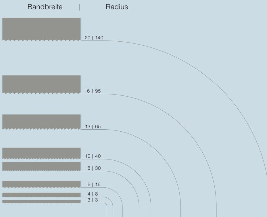
Beim Sägen von Konturen ist der kleinste zu sägende Radius von der Breite des Sägebandes abhängig. Die Blattbreite wird von den Zahnspitzen bis hin zur Rückenkante gemessen.
