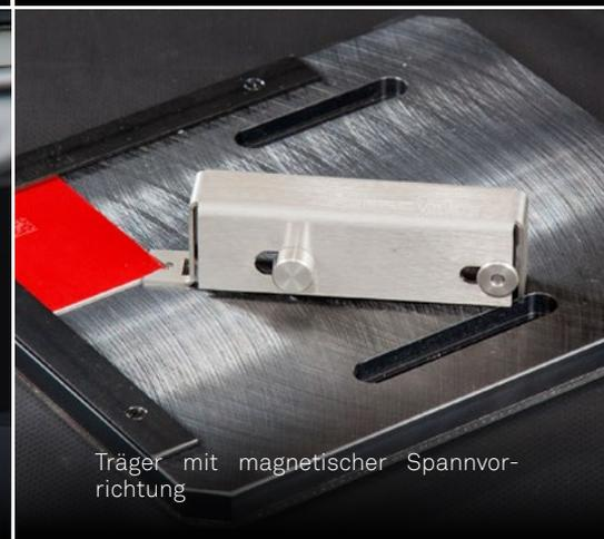
Träger mit magnetischer Spannvorrichtung
